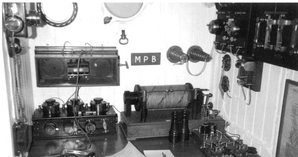
Figur 1.15 Radiohytten på ett skepp på 1910-talet. Under de båda isolatorerna står gnistinduktorn med gnistgapet på hållare. Till vänster mottagaren.
